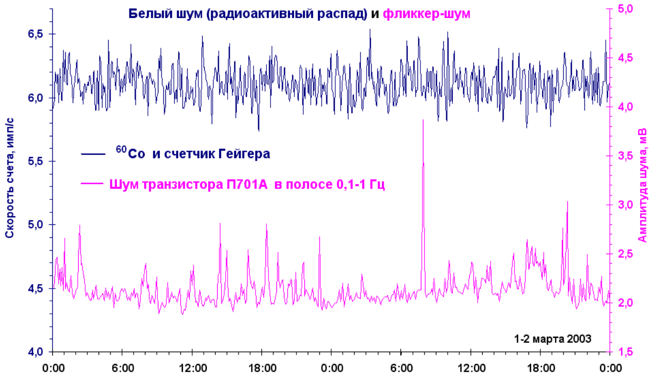
Рис. 1. Скорость счета бета-частиц ^{60}\text{Co} , измеренная счетчиком Гейгера (последовательные 5-минутные измерения) и амплитуда шума транзистора в области инфранизких частот
